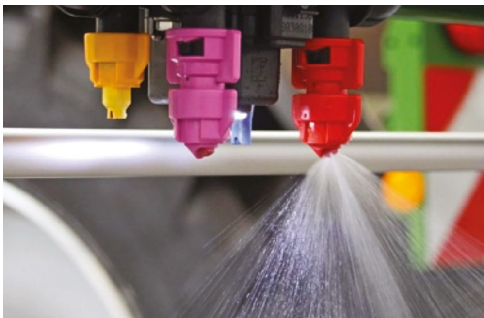
Figura 6. Cabezal compuesto por cuatro boquillas con apertura y cierre individualizado, controlado por GPS. Permite seleccionar automáticamente la boquilla operativa para adaptar la pulverización a los requerimientos específicos del momento y el lugar (AmaSelect- Amazonen -Werke H. Dreyer GmbH & Co).
