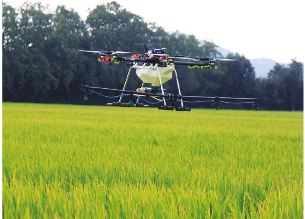
Figura 9. Tratamiento experimental con dron aplicando fungicida en los arrozales de Pals, Cataluña, España (Planas, 2018).
