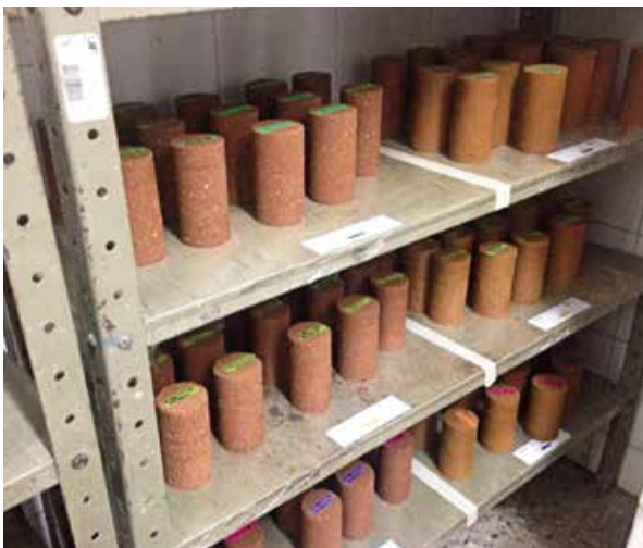
Figura 5. Caracterización mecánica de suelos estabilizados (Izq.) - Laboratorio de Geotecnia, Universidad Nacional de Colombia (Der.)
