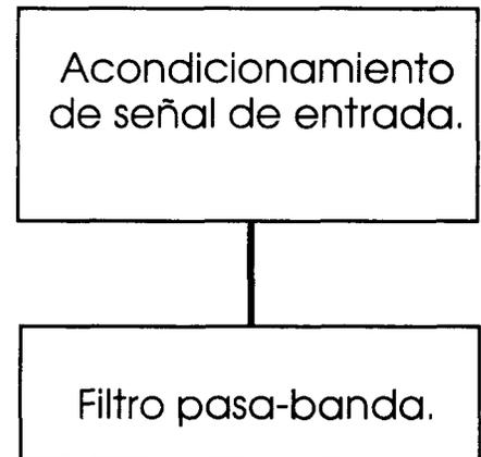
Figura 4. Etapa de filtrado. Diagrama de bloques.
