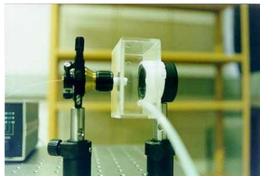
Figura 2. Fotografía del modelo construido. De izquierda a derecha se encuentra la entrada de la fibra, el modelo construido y el detector. En la parte frontal la entrada del gas a detectar.
