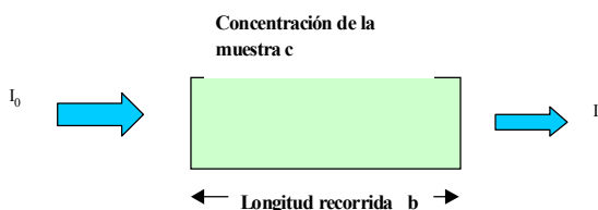
Figura 1. Concepto sobre el cual se basa la ley de Bouguer-Lambert-Beer. La intensidad de la luz que sale del modelo depende de la intensidad de entrada ( I_0 ), la concentración de la muestra ( c ) y la distancia recorrida ( b ).
