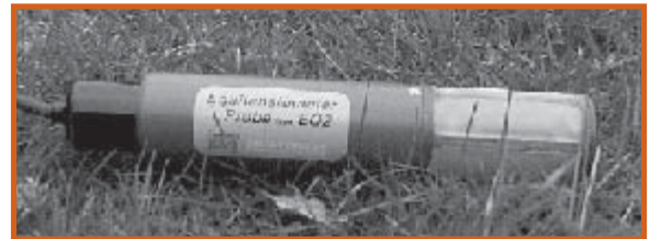
Fotografía 3. Equitensiómetro para medir la succión
