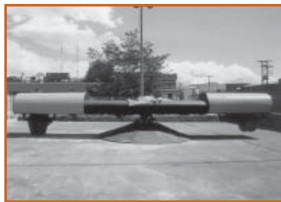
Fotografía 1. Carrusel de Fatiga del laboratorio de la Universidad de los Andes (CITEC)
