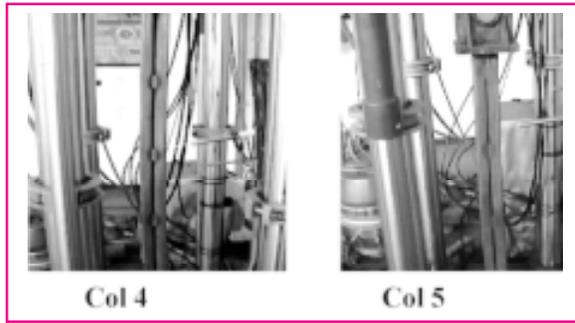
**Figura 17.** Falla por pandeo global de la columna tipo abierta 4 y 5.
