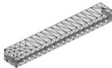
Figura 4. Modelo enmallado de la Micro-Viga
