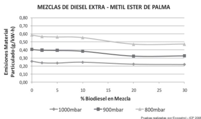
Figura 18. Mezclas diesel - biodiesel. Emisiones de material particulado.
